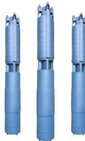
Агрегат ЭЦВ 8 предназначен для подъема воды с общей минерализацией (сухой остаток) не более 1500 мг/л, с водородным показателем (рН) от 6,5 до 9,5, температурой до 25°С, массовой долей твердых механических примесей – не более 0,01% с размером 0,1 мм, с содержанием хлоридов - не более 350 мг/л, сульфатов - не более 500 мг/л, сероводорода - не более 1,5 мг/л.
