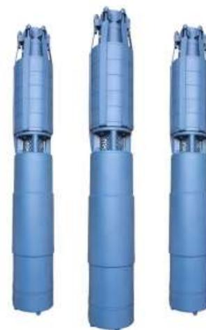
Агрегат ЭЦВ 10 предназначен для подъема воды с общей минерализацией (сухой остаток) не более 1500 мг/л, с водородным показателем (рН) от 6,5 до 9,5, температурой до 25°С, массовой долей твердых механических примесей – не более 0,01% с размером 0,1 мм, с содержанием хлоридов - не более 350 мг/л, сульфатов - не более 500 мг/л, сероводорода - не более 1,5 мг/л.
