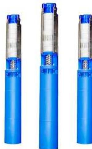
Агрегат ЗЭЦВ 12 предназначен для подъема воды с общей минерализацией (сухой остаток) не более 1500 мг/л, с водородным показателем (рН) от 6,5 до 9,5, температурой до 25°С, массовой долей твердых механических примесей – не более 0,01% с размером 0,1 мм, с содержанием хлоридов - не более 350 мг/л, сульфатов - не более 500 мг/л, сероводорода - не более 1,5 мг/л.
